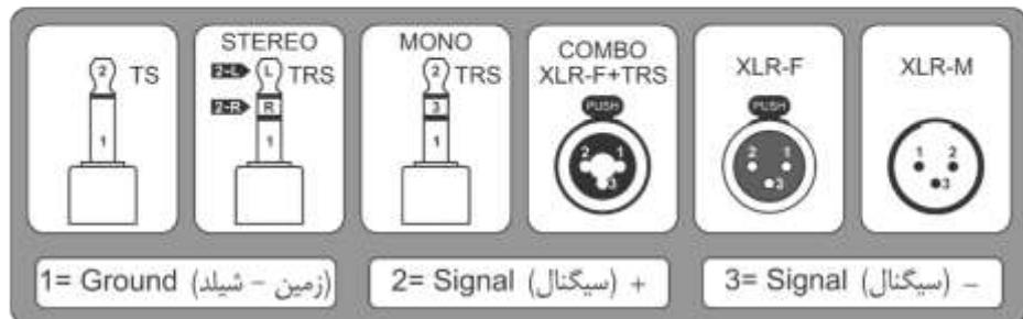
همانگونه که در اشکال بالا می بینید، سیگنال ارسالی از طریق پایه های ۲ و ۳ انتقال پیدا می کند ولی کانکتورهای TS و STEREO TRS منفی ندارند، که بهتر است در فواصل بالای ۲ متر از آنها استفاده نکنید و به جای آنها از کانکتور TRS MONO استفاده نمایید.
